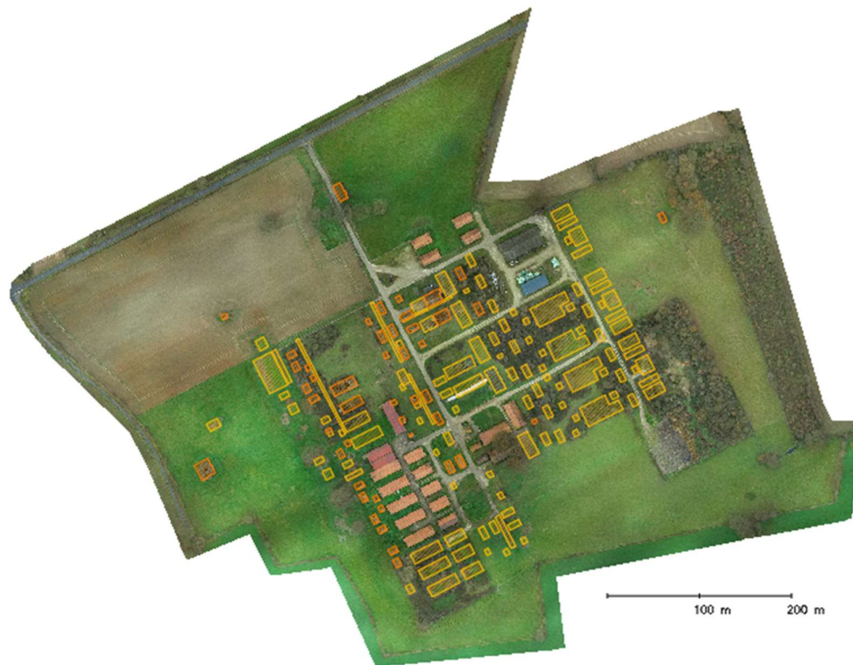
11. Travaux de désamiantage et démolitions prévus sur bâtiments (orange) et dalles béton (jaune), respectivement environ 3200 m 2 et 17700 m 2
